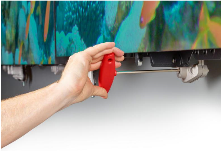
Fig. 2: Antriebsmodul für die Bewegung von Displays. Im Servicefall können im Handumdrehen ganze Säulen verschoben werden.
