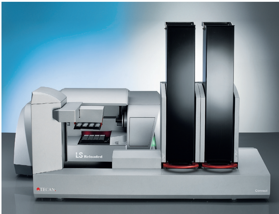
Fig. 1: Tecan Connect (vorne) in Kombination mit Tecan LS Reloaded™ (hinten) Tecan Connect: links: Greiferturm; rechts: zwei Magazine für die Aufbewahrung von Mikroplatten Foto zur Verfügung gestellt von Tecan Group Ltd.
